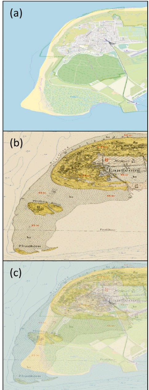
Ausschnitt von Langeoog in QGIS: (a) aktuelle Darstellung (OpenStreetMap), (b) historische Darstellung (Geologische Karte 1: 25.000 von 1915) und (c) Überlagerung beider Karten (Transparenz)
